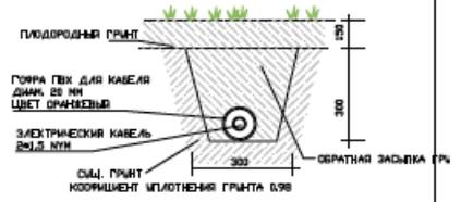
РАЗРЕЗ УСТАНОВКИ СВЕТИЛЬНИКОВ
